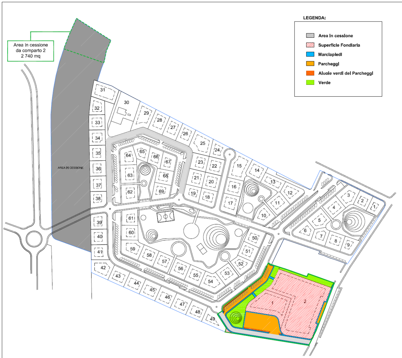
Figura 3 - Planimetria generale sub comparto 2 con individuazione delle superfici destinate a standard pubblici e all'edificazione fondiaria.
