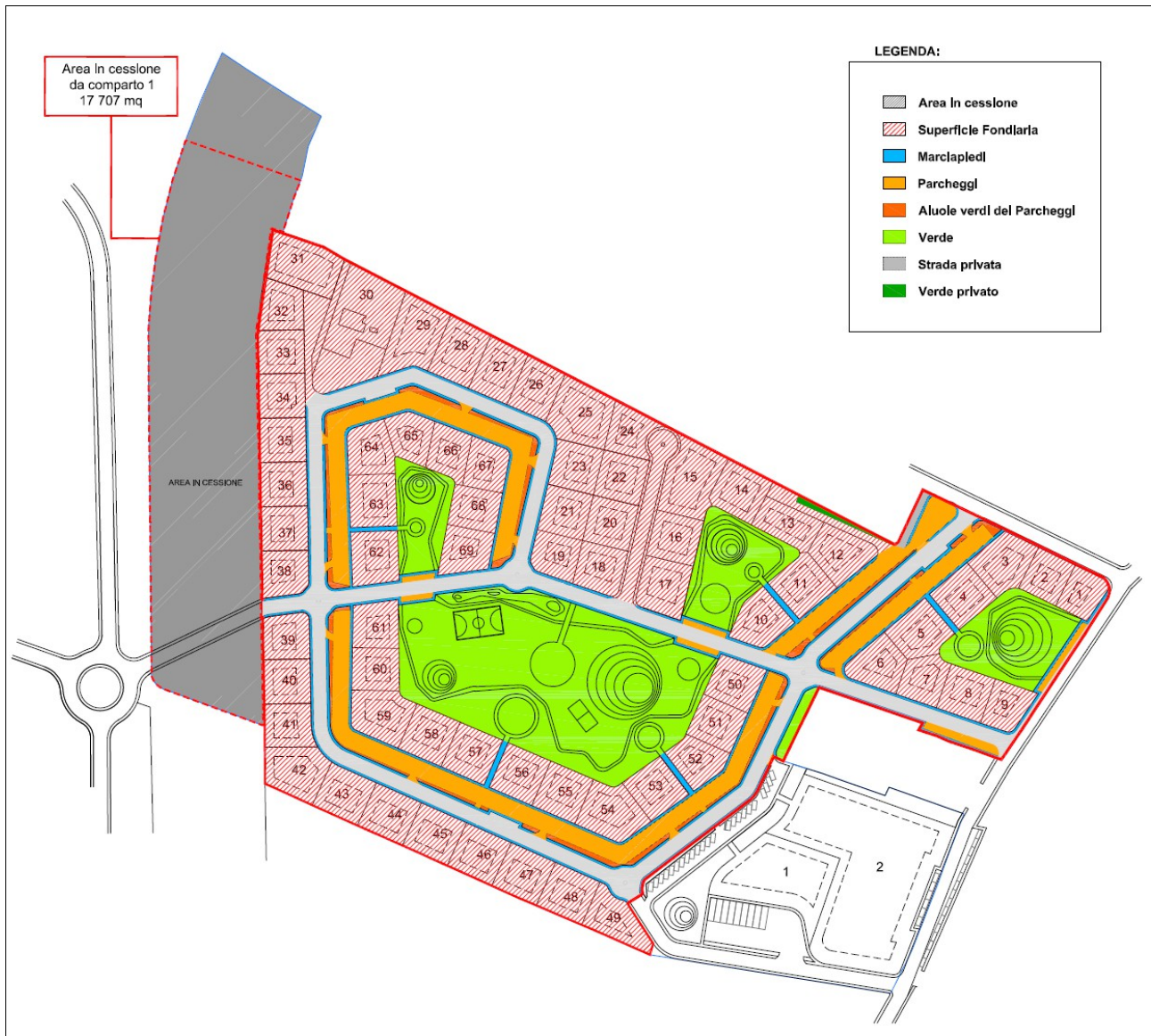
Figura 2 - Planimetria generale sub comparto 1 con individuazione delle superfici destinate a standard pubblici e all'edificazione fondiaria.
